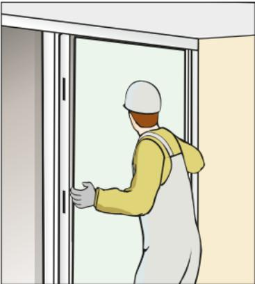
Para sujetar la placa Coreboard insertaremos los perfiles de fijación uno en cada montante, entre éste y la placa.
